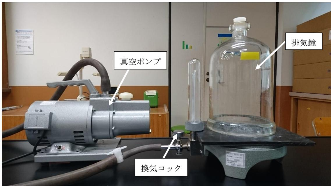
図 C-1 排気鐘と真空ポンプをつないだ写真
