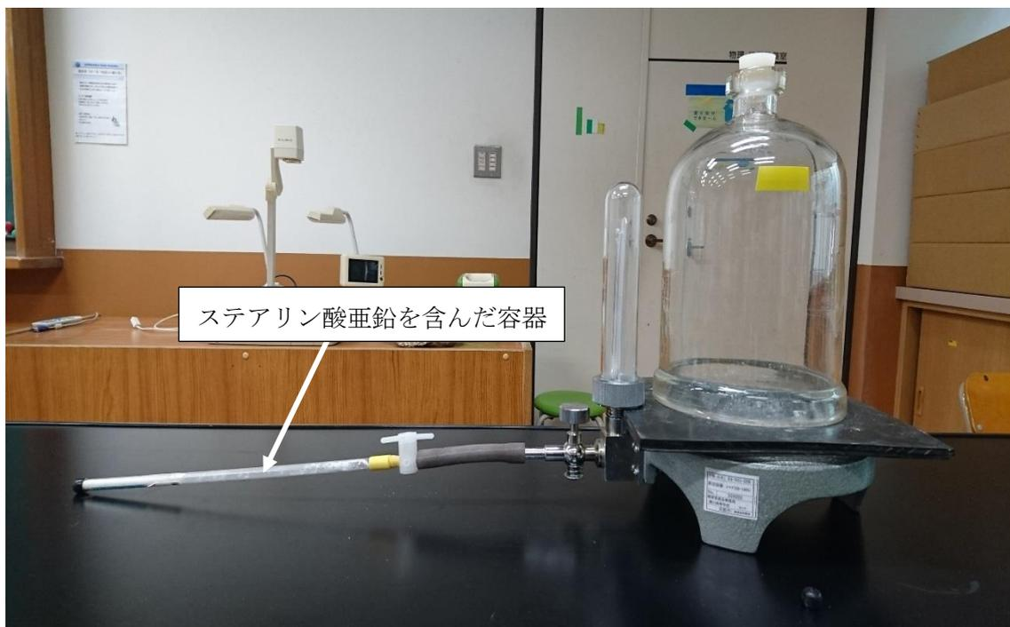
図 C-2 排気鐘とステアリン酸亜鉛を含んだ容器をつないだ写真
